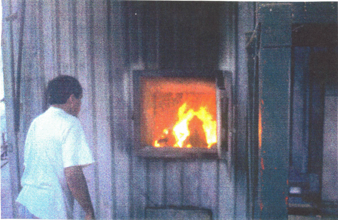
La Industria Beneficiadora de Café de la Región utiliza combustibles biomásicos (cascarilla y leña) en el proceso de secado del “Grano de Oro”
